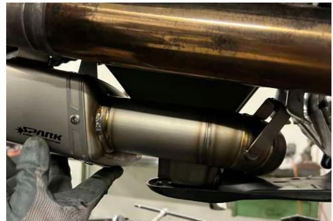
**3. Avvitare le staffe rimosse dallo scarico originale ed installare lo scarico avvitando le staffe al telaio utilizzando le viti originali e i dadi in dotazione.**
