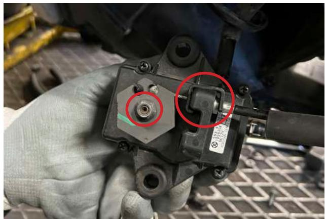
**5. Rimuovere il cavo della valvola e rimontare la centralina. (ESCLUDERE ELETTRONICAMENTE LA VALVOLA CON LA RIMAPPATURA DELLA CENTRALINA)**
