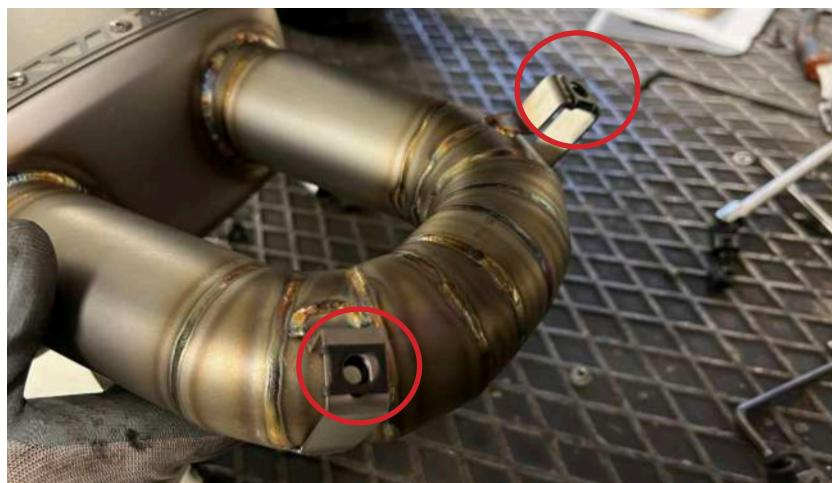
**2. Rimuovere la vite indicata in foto e inserire lo scarico Spark.**
