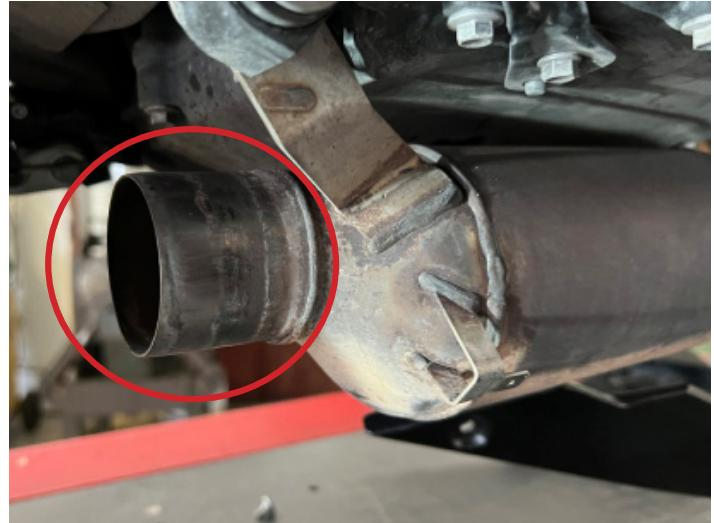
**1. Inserire la fascetta sul raccordo ed installare il raccordo Spark sul catalizzatore originale.**
