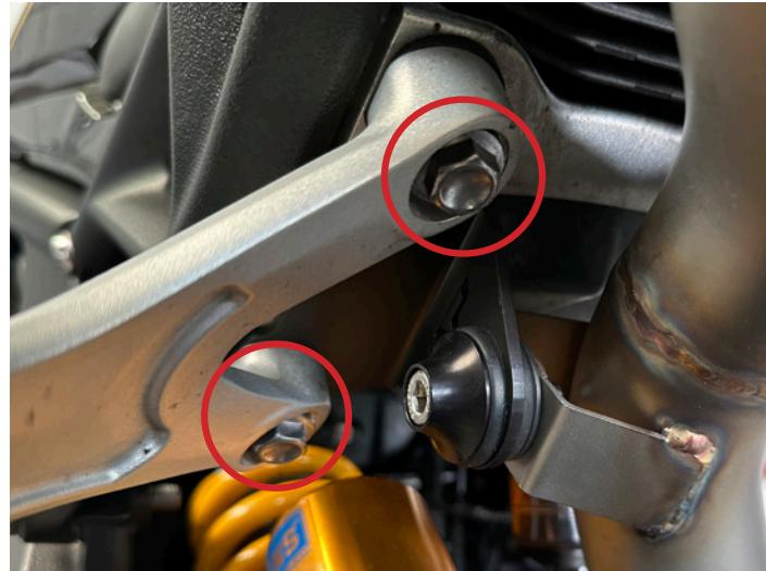
**3. Fissare lo scarico alla staffa utilizzando i distanziali mostrati in foto e la vite e il bullone in dotazione.**
